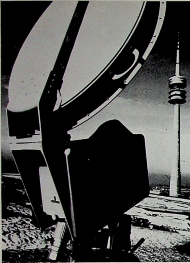
Afb. 6. Toepassing van straalverbindingen op microgolf: een volledige reportage installatie voor TV.
